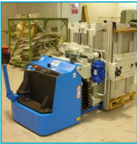
● ARGO AIR retourne-pile mobile avec air et égalisation ARGO AIR volteador de pilas móvil con aire y alineación
