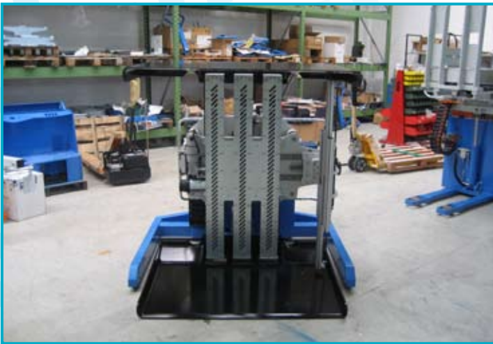
● ARGO AIR avec plate-forme retourne-pile mobile à air avec égalisation ARGO AIR con plataforma volteador de pilas móvil con aire y alineación
