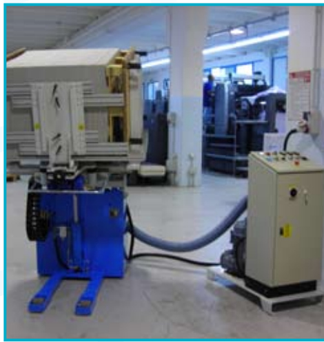
● ARGO AIR retourne-pile mobile avec air et égalisation ARGO AIR volteador de pilas móvil con aire y alineación
